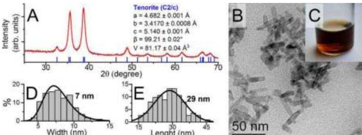
Рис. 2. А – Дифрактограмма образца; В – микрография наночастиц CuO; С – внешний вид разбавленного золя; D, Е – гистограммы распределения частиц по диаметру и длине
