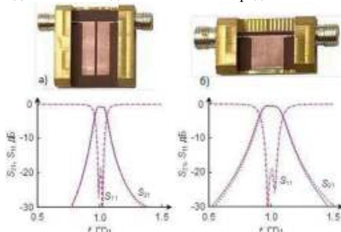
*Рис. 1 Фотографии экспериментальных образцов двух конструкций двухзвенных фильтров на а) полуволновых и б) четвертьволновых МПР и их АЧХ. Линии – расчет, точки – эксперимент*
