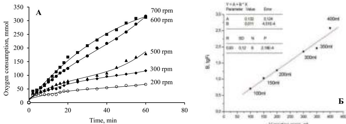
Рисунок 1. Влияние скорости перемешивания на кинетику поглощения  $O_2$  при окислении древесины сосны, 300 мл (А) и зависимость  $\text{tg}\phi$  от объема реакционной массы.
