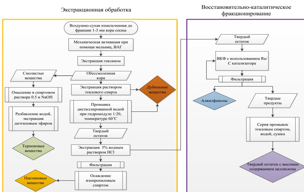
*Рис. 1. Схема эксперимента комплексной переработки коры сосны*
