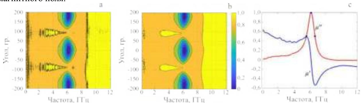
*Рис. 1. Результаты измерения образца  $Ni_{80}Fe_{20}$  толщиной 200 Å (а – нормированное значение модуля  $S11$  (б – после применения цифровой фильтрации); с – нормированное значение действительной и мнимой частей комплексной магнитной проницаемости)*
