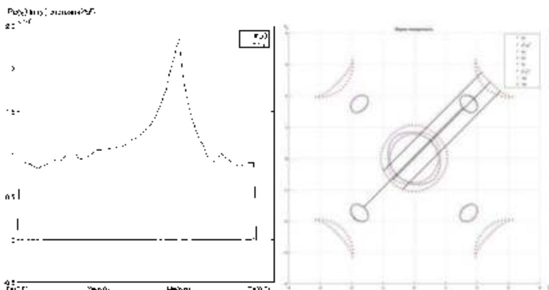
Рис. 1. Слева –  $Re(\chi)$  и  $Im(\chi)$  на нулевой частоте  $\omega = 0$  эВ как функции импульса  $q \in \Gamma\text{ХГМ}$ . Справа – поверхность Ферми и характерные вектора, рассеяние на которых даёт максимальный вклад в спиновую восприимчивость
