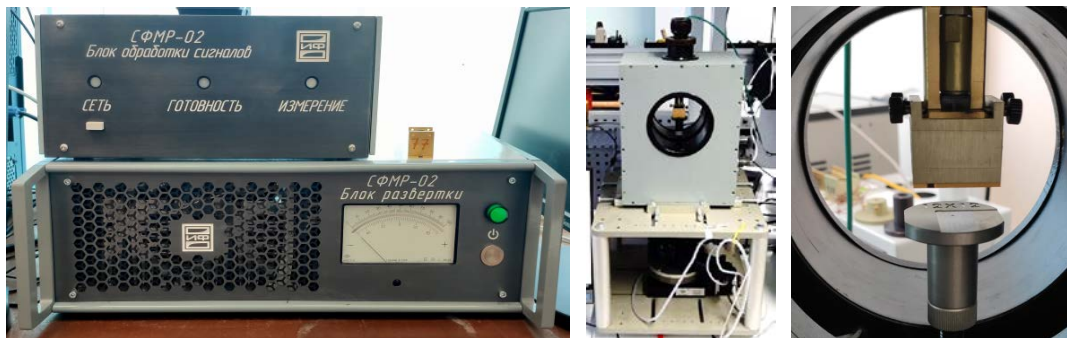
Рис. 1. Блок развёртки и обработки сигналов (слева), система перемещения образца и магнитная система (по центру), измерительная головка и держатель образца внутри магнитной системы (справа)
